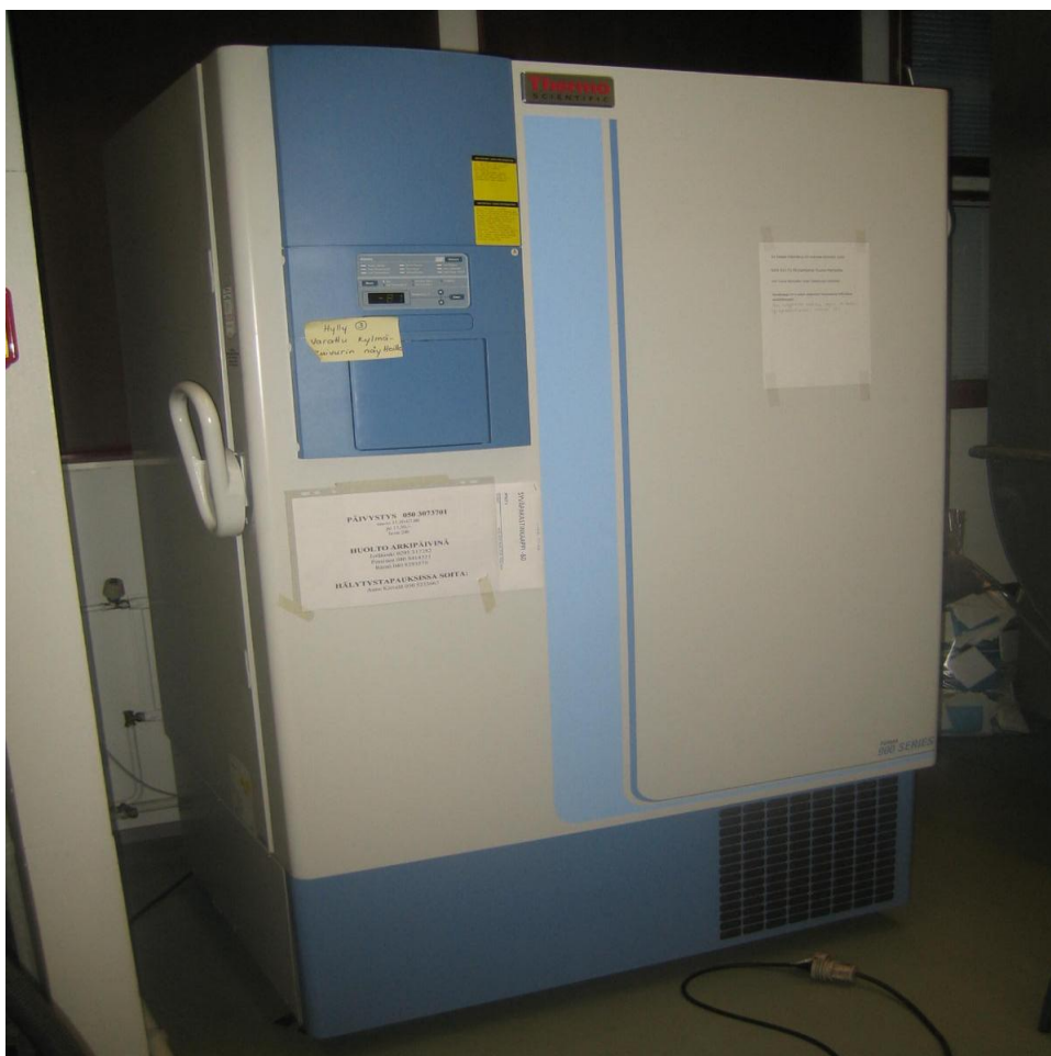
Kuva 4. Syväpakastin, jossa lämpötila -80\text{ }^{\circ}\text{C} (Talvisilta 2012.)
