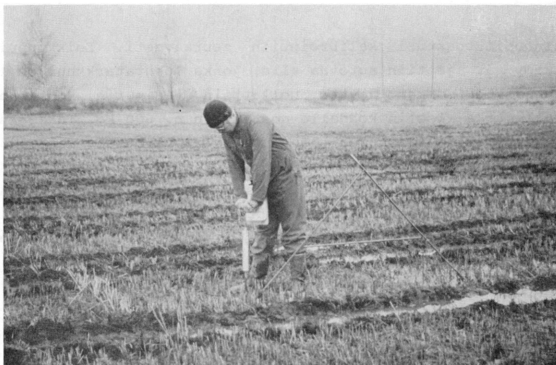
Kuva 11. Maan kovuuden mittaukseen käytetty cone-index-penetrometri
