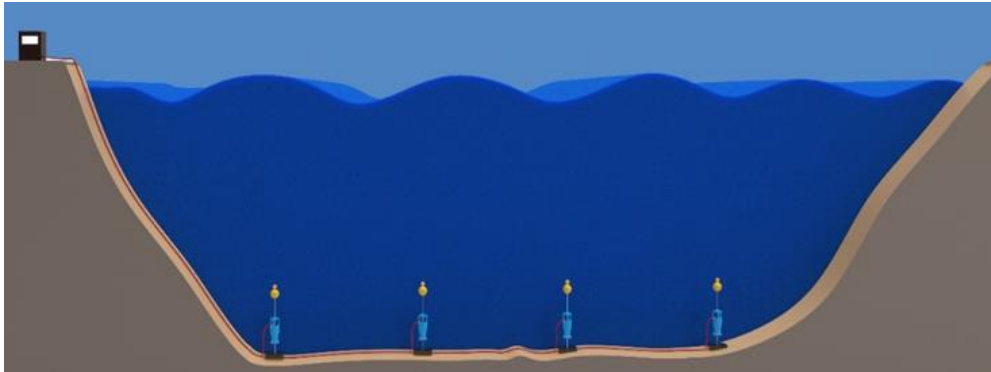
Kuva 9. Kaaviokuva hyljekarkottimien asentamisesta salmen pohjan tuntumaan. Karkottimien etäisyyttä pohjasta voidaan säätää ankkuriköyden pituuden avulla. Lehtonen ym. (2023)
