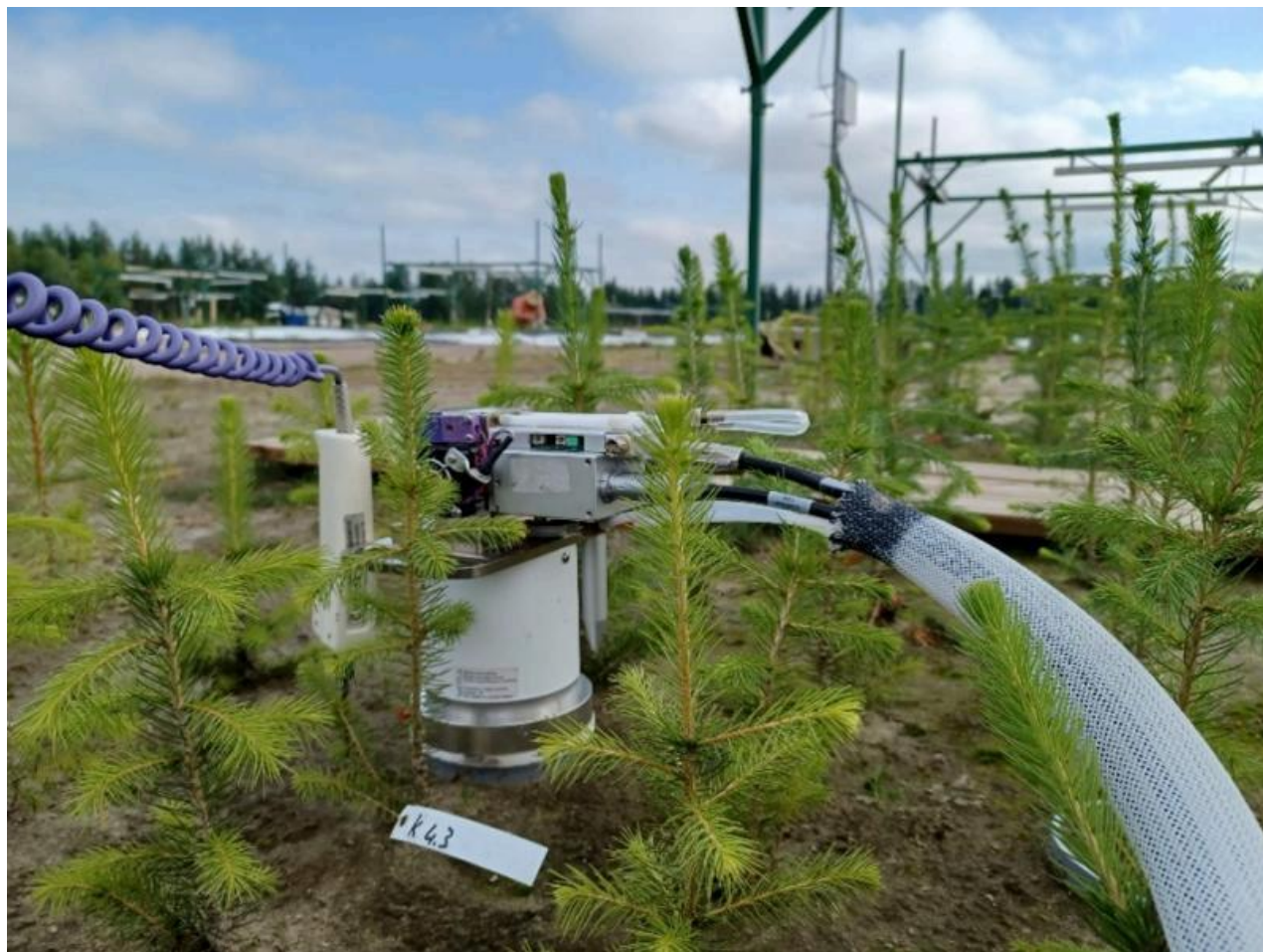
Maaperästä vapautuvaa hiilidioksidia mitataan maahengityskammiolla. Kuva Katri Himanen / Luke
