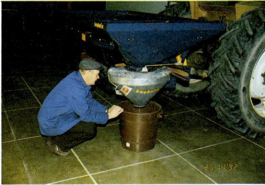
Tehtäessä kiertokokeita keskikoplevittimellä lannoite kerätään suppilon avulla saaviin.
