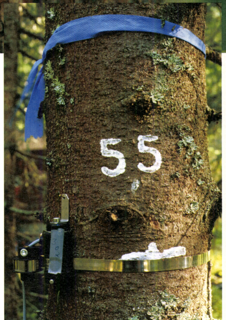
Kuusiin on asennettu automaattinen kasvupanta 1,3 metrin korkeudelle. Kun puun ympärysmitta lisääntyy tai pienenee, pantaan liitetyn säätövastuksen vastusarvo muuttuu. (Kuva: Erkki Oksanen)
