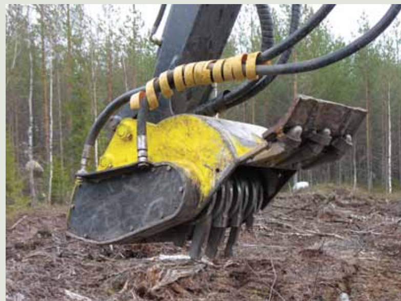
Kuva 1. Kaivinkoneen puomin päässä oleva Havel-jyrsin. Vertailukäsitte-lynä ollut laikutus tehtiin jyrsimen etureunaan kiinnitetyllä teräslevyllä. Jyrsimen kyljessä näkyvät siemensuuttimet. (valokuva Pekka Helenius)
