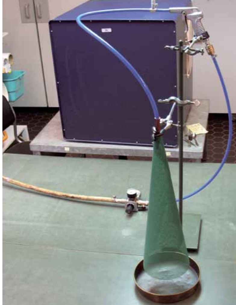
Kuva 1. Siementen ampumiseen käytetty laitteisto sekä kovana puhallusalustana alustana käytetty messinkinen astia. Pehmeä alusta tehtiin kaatamalla saman astian pohjalle 10 mm paksuinen kerros hienoa hiekkää. Suuttimen etäisyys alustasta oli molemmissa käsittelyissä 80 cm. (valokuva Pekka Helenius)
