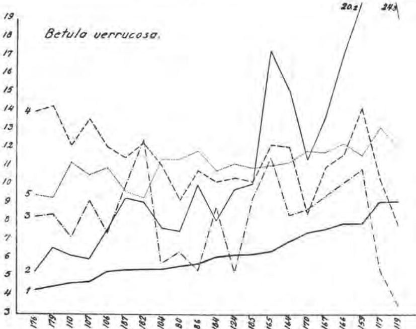
Diagrammi 3. Eräiden rauduskoivun ( Betula verrucosa ) koekappaleiden taivutuslujuus ja siihen vaikuttavia tekijöitä. — 1. Taivutuslujuus (sadoissa \text{kg/cm}^2 ); 2. vuosilustojen lukumäärä 20 mm:n matkalla; 3. putkiloiden lukumäärä 1 103 \text{mm}^2 :n alalla (kymmenissä). 4. Putkilo-%; 5. Puusyiden pituus (sadoissa \mu :issä).
