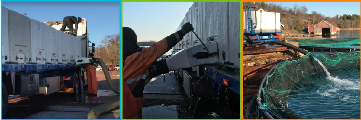
Kuva 5. Kuvasarja kalojen purkamisesta kuljetusautosta suoraan verkkoaltaaseen, joka on hinnattu rantaan kalanpoikasten vastaanottamiseksi. Purkuputki kiinnitetään tankkiin, josta kalat vapautetaan veden mukana putkea pitkin. (Kuva: Ella Hellström.)
