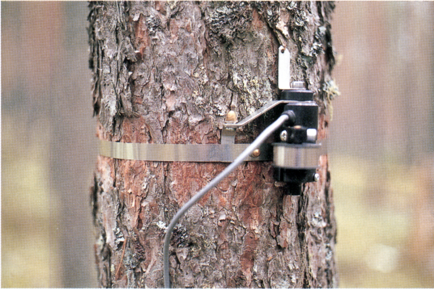
Kuva 35. Puun sädekasvua mittaava kasvupanta.
