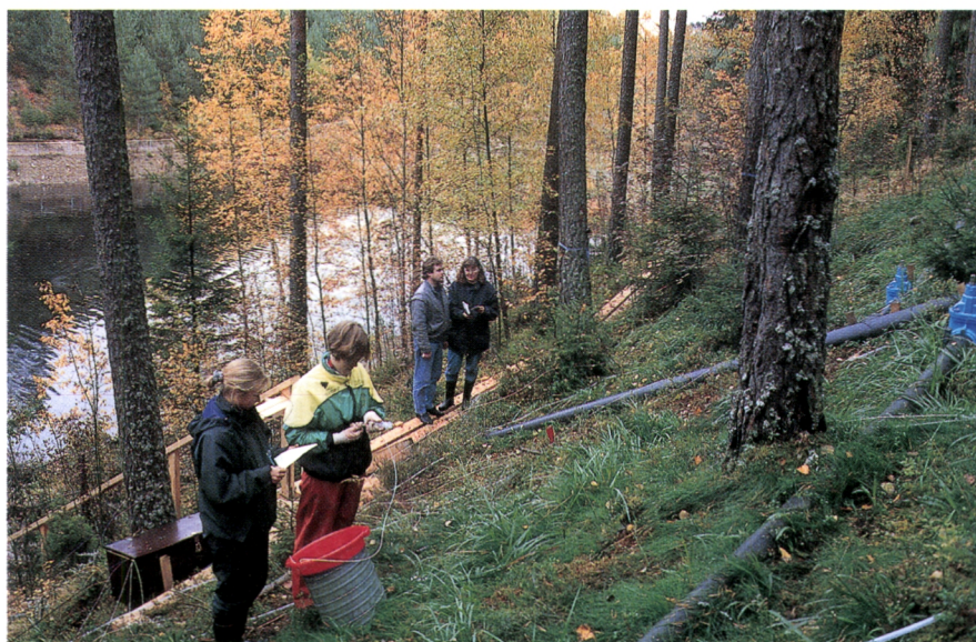
Kuva 5. Typpioksiduulin ( N_2O ) tuoton mittausta Ahveniston harjulla syksyllä 1997.
