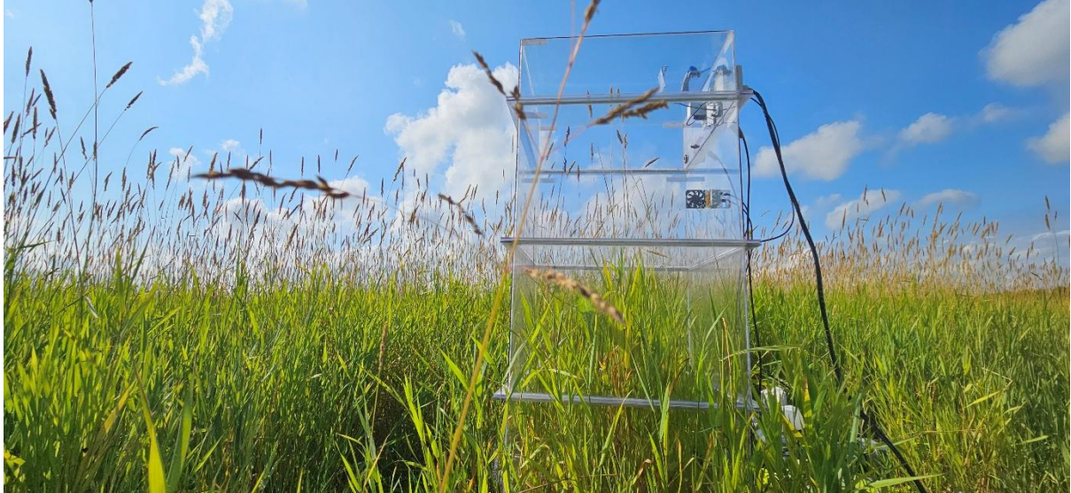
Kuva 24. Kasvihuonekaasujen mittausta kammiomenetelmällä suonpohjan ruokohelpiviljelmällä. Kuva: Pasi Arkko / GTK.
