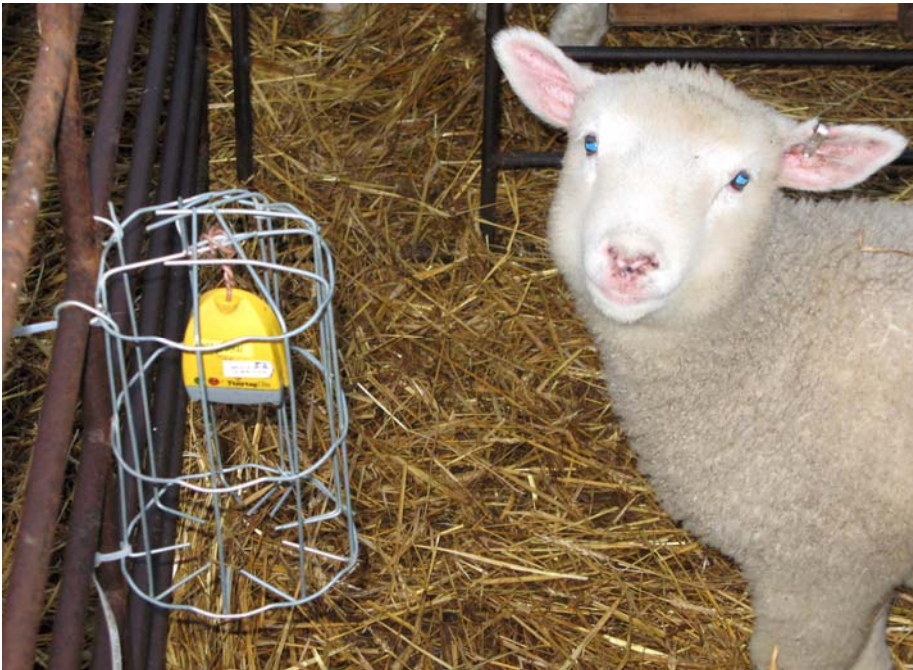
Kuva 4. Lämpötila- ja kosteuslukemien datakeräin eläintilassa. (Kuva: Tapani Kivinen)
