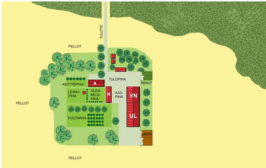
Kuva 38. Uudisrakennusaikakauden maatalon talouskeskus: A = asunto, K = konevaja, VN = vanha navetta, joka on korjattu lampolaksi = UL. Vanhan navetan päätyyn on tehty uusi lantala ja rehusiilot toiseen päätyyn.
