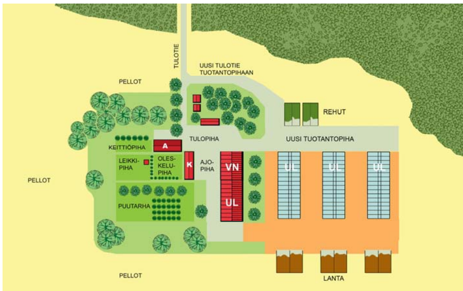
Kuva 39. Uudisrakennusaikakauden maatalon talouskeskus: A = asunto, K = konevaja, VN = vanha navetta, joka on korjattu lampolaksi = UL. Toiminnan laajentuessa uusia kevythalleja = UL rakennetaan niin, että muodostuu uusi tuotantopiha. Tuotantopihaan keskitetään rehu- ja lantavarastot toisistaan erilleen. Myös uusi ajoreitti tuotantopihaan voi tulla ajankohtaiseksi.
