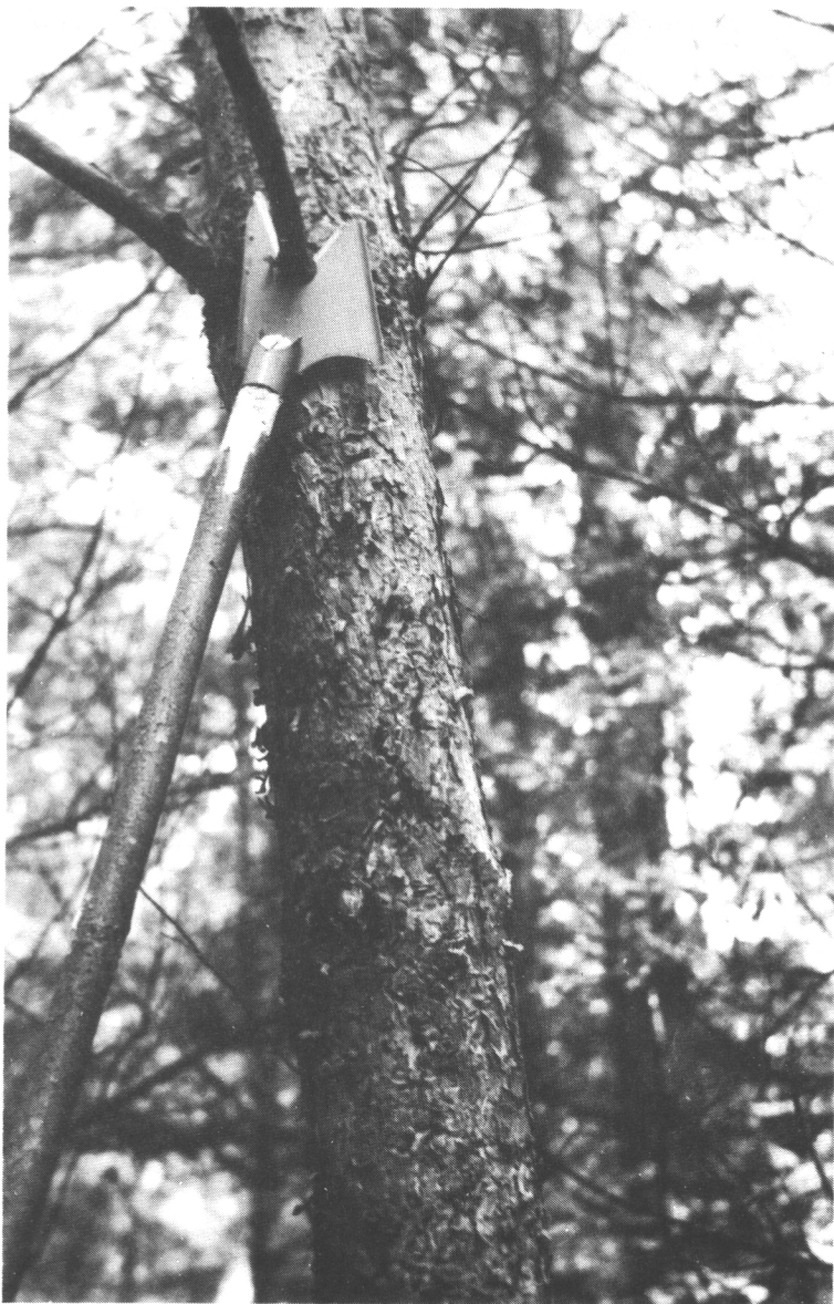
Kuva 1. Starostin'in lovileikkuri. Fig. 1. Starostin's branch cutter.
