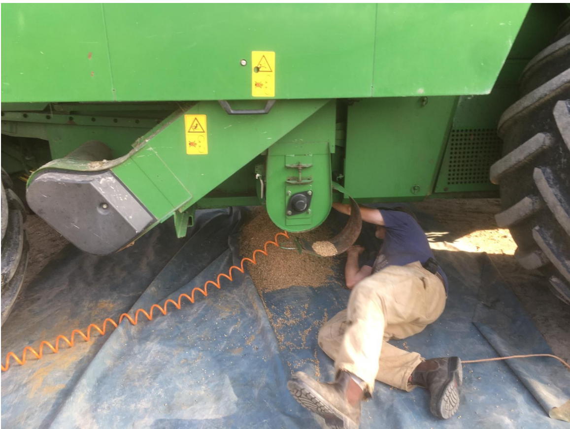
Kuva 14. Pienen siemenerän talteenotto normaalikokoisesta puimurista alakautta. Kuva: Hannele Moisander.
