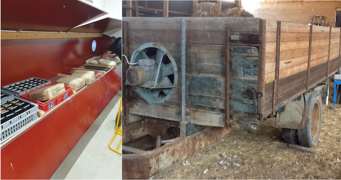
Kuva 19. Vasemmalla olevaan tanskalaisen Anders Borgenin rakentamaan laatikkokuivuriin voi asettaa hyvin pieniäkin siemenmääriä koreissa. Kuva.: Hushållningssällskapet försöksgård Logården. Oikealla peräkärrykuivuri. Kuva: Paul Teepen.
