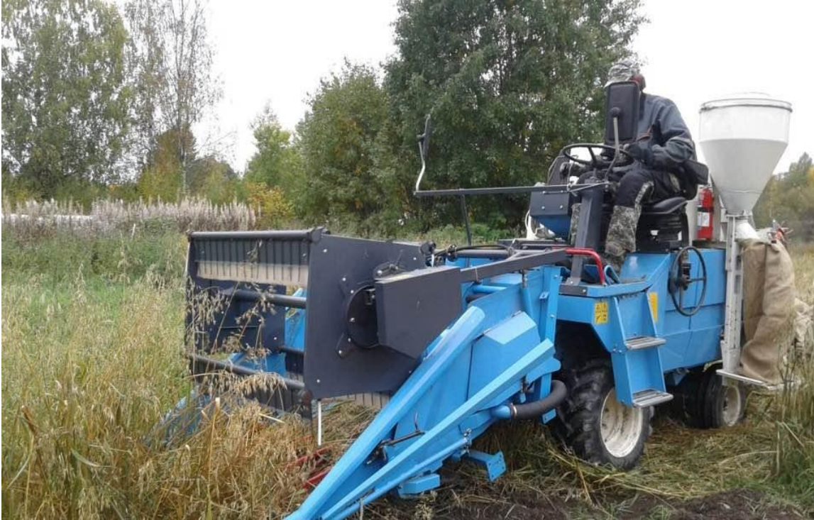
Kuva 11. Tutkimustoiminnassa käytettävät koekenttäpuimurit soveltuvat myös hyvin pienten alojen puintiin. Tämä puimuri pui säkkiin ja roskat tulevat mukaan. Kuva: Annika Michelson.
