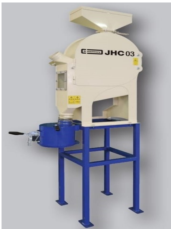
Kuva 28. Kuvassa on JHC-pienkuorija. Tämä kone on suunniteltu kuorimaan viljoja. Sen kuorintatapa on hellävarainen. Kone on pieni ja sen rakenne kompakti. Sen toimintatapa on pölytön. Kuorinnan tehokkuutta voi helposti säätää. Tämä kone ei kuori kauraa 100 % kuorettomaksi. Kuva. JK Machinery.
