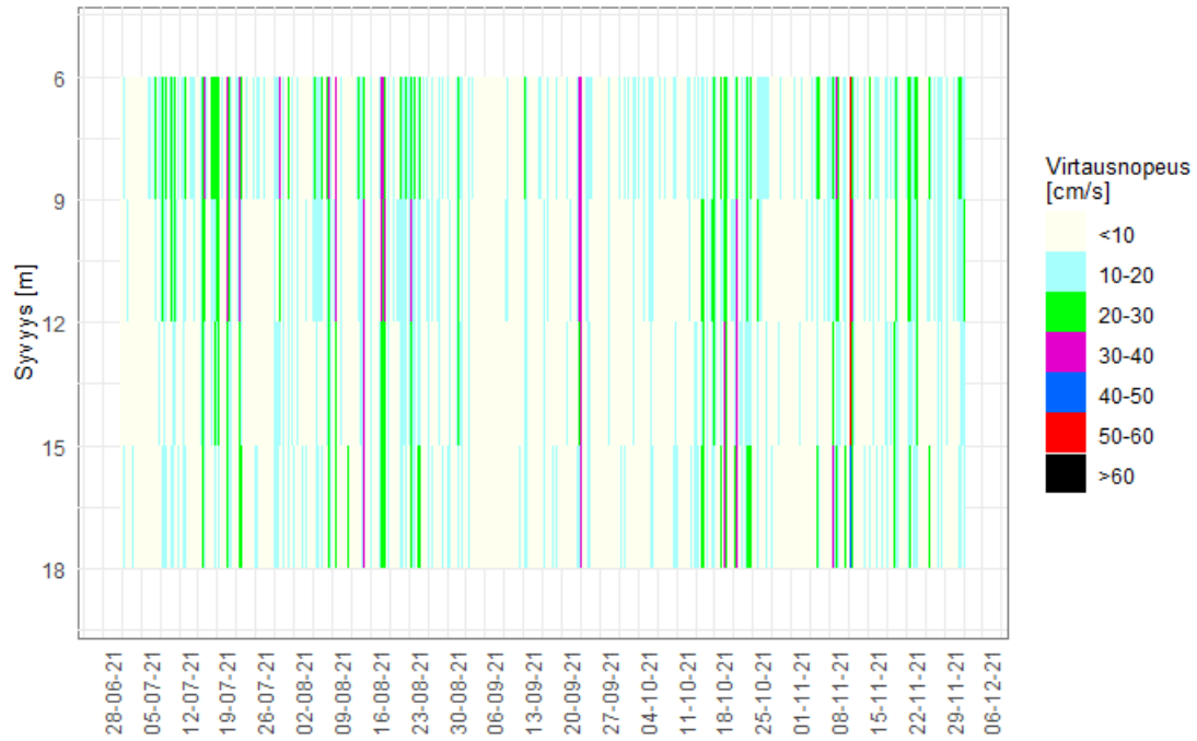
Kuva 28. Vesipatsaan virtausnopeusprofiili ‡ verkkokassin syvyydellä (6–18 m) Korran laitoksella 1.7.–2.12.2021.
