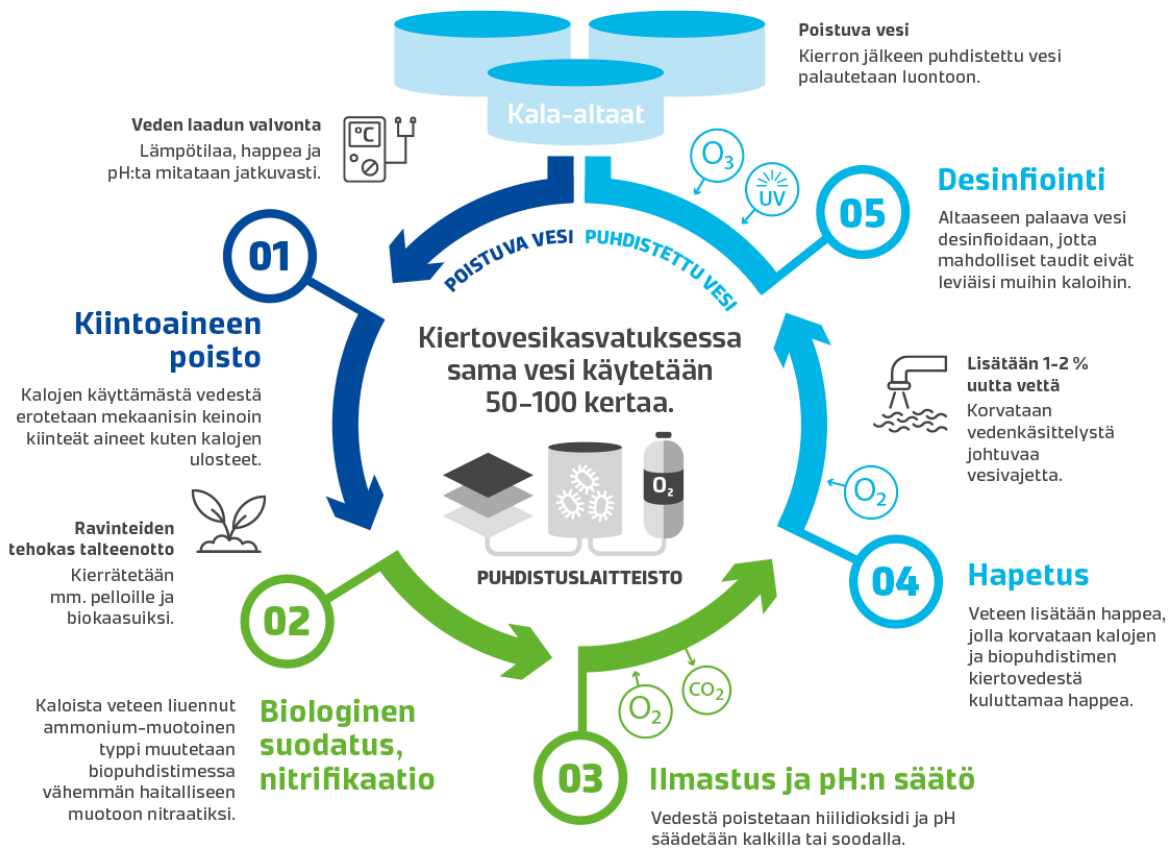
Kuva 1. Kalojen kiertovesikasvatuksen periaatteet
