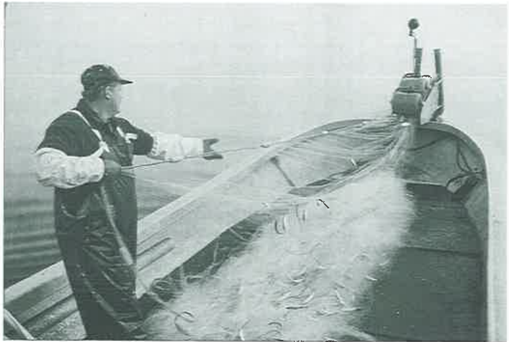
Investoimalla verkkojen vetokoneeseen pyhämaalaiset kalastajat ovat nopeuttaneet pyydysten nostoa, mikä parantaa saaliin säilyvyyttä. Kalastaja Seppo Saari nostamassa silakkaverkkoja. Valokuva Pekka Salmi.
