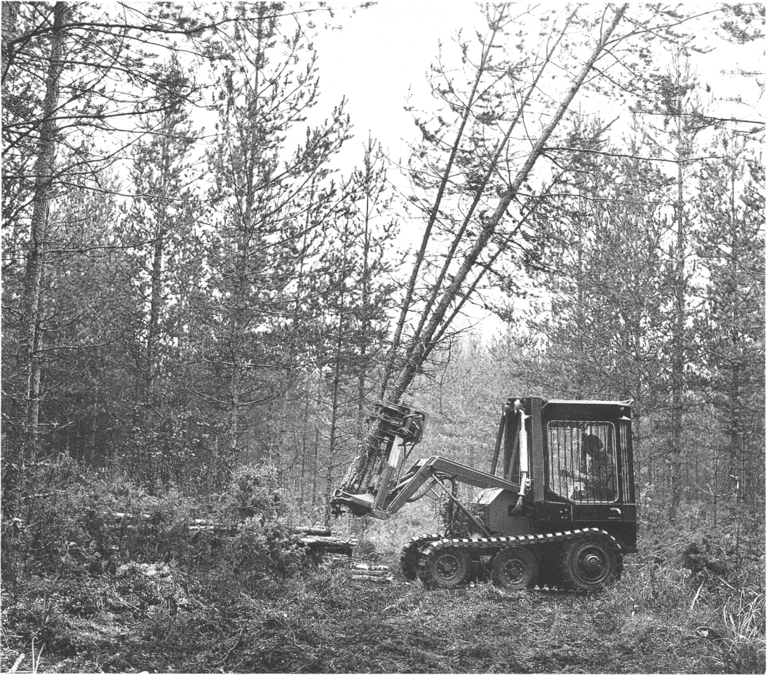
Figur 10. Makeri fällare-sammanförare (Foto: Skogsforskningsinstitutet).
