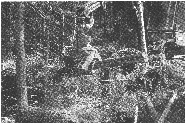
Figur 14. Valmet 901 med Valmet 942 engreppskördareaggregat. En entreprenör har visat att man med detta aggregat kan hantera träd stående och tack vare separat manövrering av drivrullar och kvistknivar även ackumulera flera träd vid fällning. De ackumulerade träden upparbetas också tillsammans. Att detta kan ge prestationshöjning är lätt att inse. En sådan maskintyp är klart intressant att utveckla vidare. (Foto: Metsäteho).
