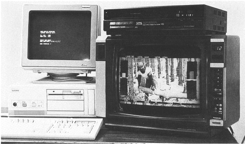
Figur 4. Med ett tilläggskort i datorn kan man på videobilden banda muskelspänningens storlek, som i televisionsbilden invid syns som en stapel skilt mätta för den vänstra och den högra ryggmuskeln. De nedre smala stolparna visar muskelspänningen under ca 10 sekunders tid. För att kunna analysera muskelspänningarna och arbetsställningarna samtidigt gjordes ett dataprogram (Foto: Nurmi-Foto).
