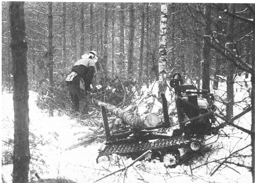
Figur 1. Minilunnaren gör skogsarbetarens arbete mera omväxlande. Lasten används som arbetsbänk, varvid kvistningen och lastningen sker lätt och säkert (Foto: Arto Mutikainen).
