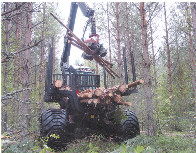
Рисунок 1.7. «Valmet Combi» работает на первой рубке ухода в сосновом древостое. (Фотография: АО «Komatsu Forest Oy»)
