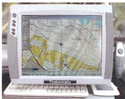
Рисунок 2.17. Система GIS включает базовую карту и дополнительные данные о делянке. GPS размещает машину на карте. (Фотография: АО «Timberjack»)
