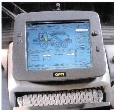
Рисунок 2.16. Система управления машиной «Ponsse Opti» указывает оператору на узлы, нуждающиеся в обслуживании или ремонте. (Фотография: АО «Понссе»)
