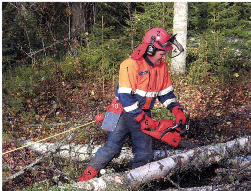
Рисунок 4.1. Снаряжение вальщика: 1 – защитный костюм; 2 – каска; 3 – наушники; 4 – маска; 5 – сапоги с защитными накладками; 6 – перчатки; 7 – пелерина; 8 – цепной тормоз; 9 – рулетка; 10 – крюки. (Фотография: Юха Лайтила)
