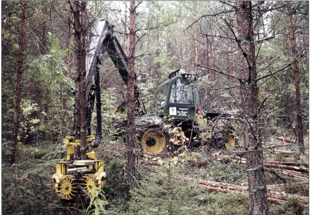
Kuva 15. Timberjack 745 harvesteripäällä varustettu Timberjack 870 hakkuukone soveltaa joukkokäsittelytekniikkaa ensiharvennusmännikössä työskennellessään (kuva Pentti Hakkila).
