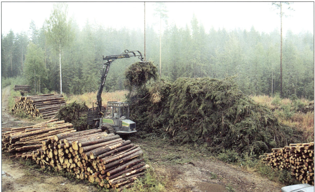
Kuva 11. Hakkuutähde kuljetetaan tien varteen vakiorakenteisella kuormatraktorilla, joka voidaan varustaa erikoisrakenteisella kouralla ja laajennetulla kuormatilalla (kuva Jaakko Miettinen).
