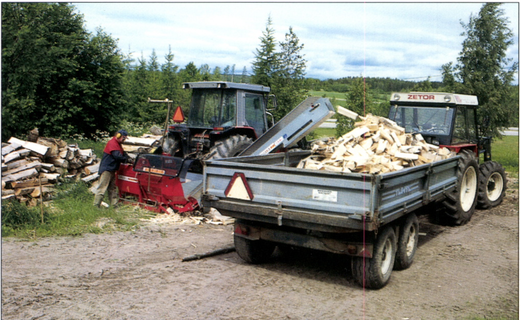
Kuva 9. Palax katkaisu-halkaisukone tekemässä pilkettä yksimetrisestä halosta (kuva Hannu Kalaja).
