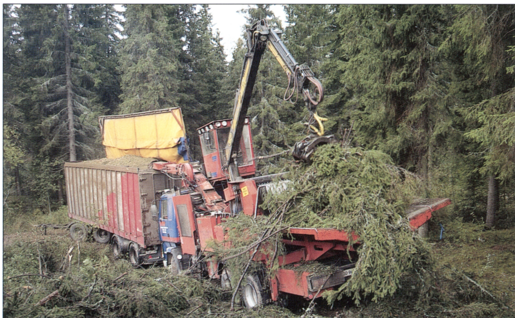
Kuva 12. Kotimaiset Energiat Ky Pekka Lahden kuorma-autosovitteinen Evolution rumpuhakkuri valmistamassa hakkuutähdehaketta (kuva Jaakko Miettinen).
