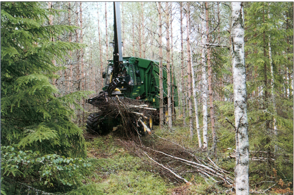
Kuva 10. Chipset palstahakkuri valmistamassa kokopuuhaketta ensiharvennusmetsikössä (kuva Oy Logset Ab).
