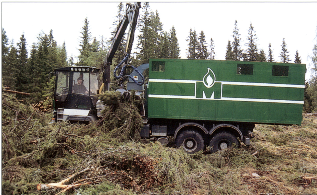
Kuva 13. MOHA hakkurikuorma-auto valmistamassa hakkuutähdehaketta uudistus-hakkuualalla (kuva Jaakko Miettinen).
