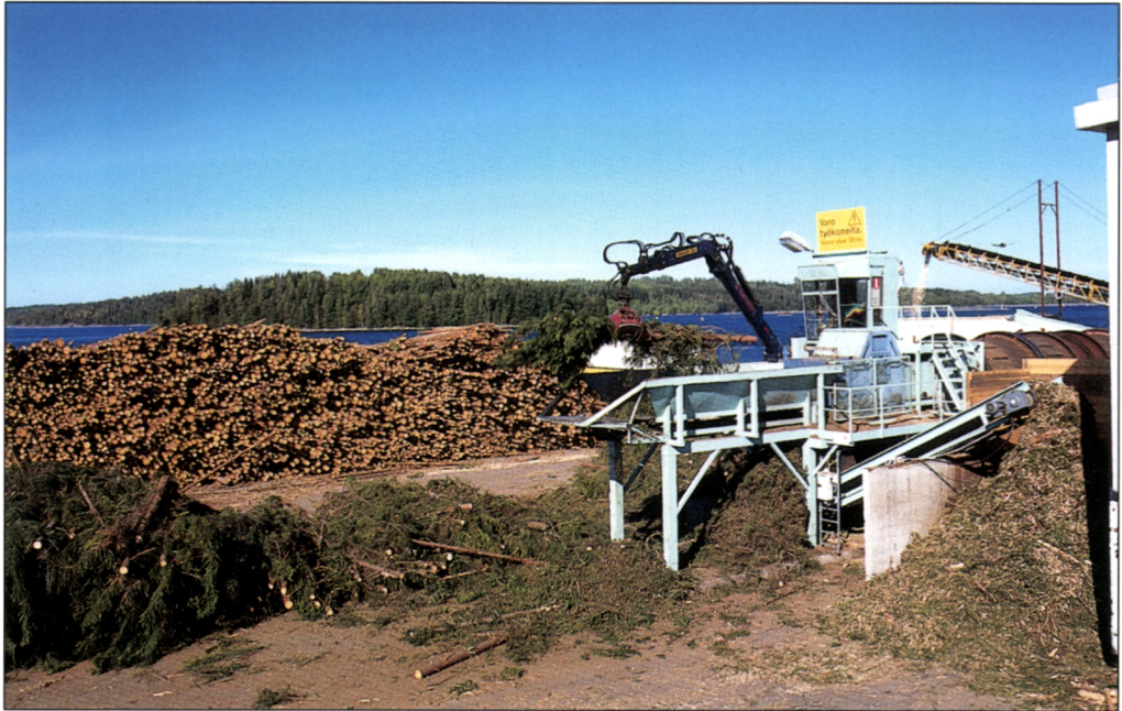
Kuva 16. Pertti Szepaniak Oy:n ketjukarsija-kuorijasta, pienrummusta, hakkurista ja hakeseulasta koostuva ensiharvennuspuun käsittelyasema Enso Oy:n Kaukopian tehdasvarastolla (kuva Hannu Kalaja).
