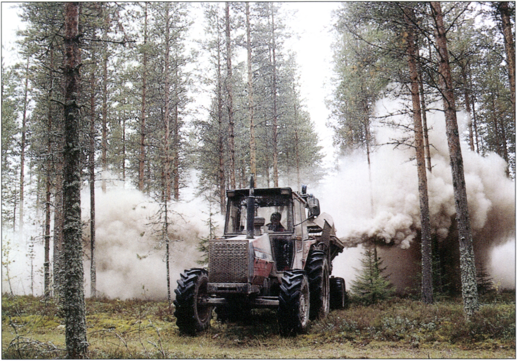
Kuva 32. Tuhkan levitystä koneyrittäjä Heikki Huuhan kehittämällä maataloustraktorisovitteisella laitteistolla. Pölyämisen rajoittaminen edellyttäisi tuhkan rakeistamista (kuva Pentti Hakkila).
