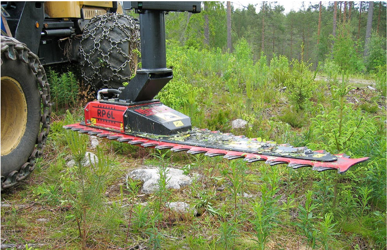
Kuva 4. Mense RP 6 L –raivauspää asennettuna kuormatraktorin puomiin. (valokuva Veli-Matti Saarinen)
