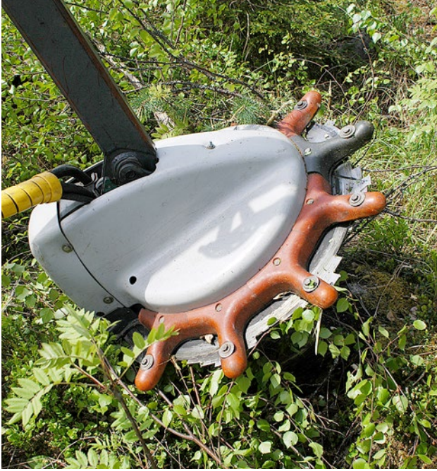
Kuva 2. UW 40 -risuraivaimen terä. (valokuva Ville Kankaanhuhta)
