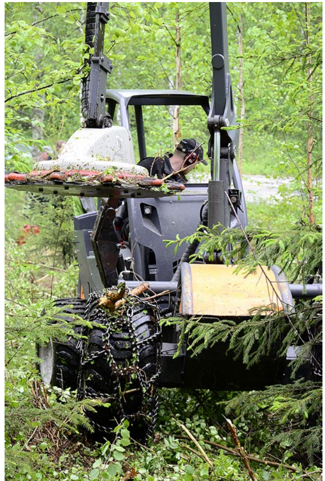
Kuva 1. Usewood Tehojätkä -pienmetsäkone UW40 -risuraimella varustettuna (valokuva Ville Kankaanhuhta)
