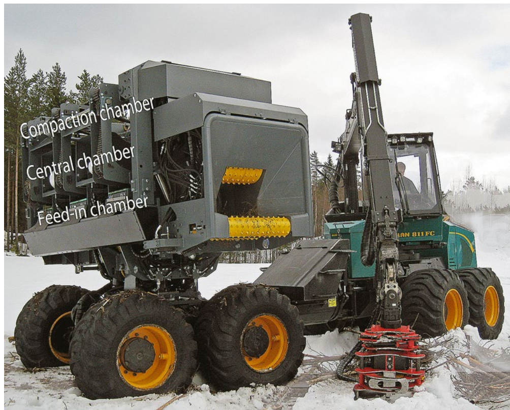
Kuva 1. Fixteri-paalainyksikkö muodostuu syöttökammariosta (feed-in chamber), keskikammariosta (central chamber) ja pakkausammariosta (compaction chamber). (valokuva Rolf Björheden, Skogforsk).
