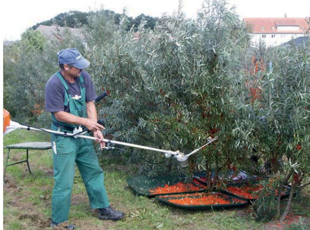
Kuva 91. Virossa kehitetty ravistelija HK2 on rakennettu siimaleikkurin runkoon. Kuva Friedrich Höhne.
