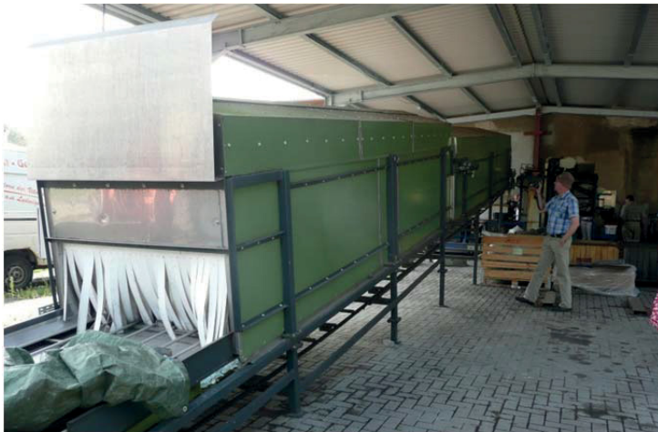
Kuva 68. Kranemann-yrityksen valmistama tyrnipuumuri. Kasvuston ohjaimet on kuvassa kokoontaitettuna. Havainnollisia puintikuvia löytyy Kranemannin nettisivuilta.
