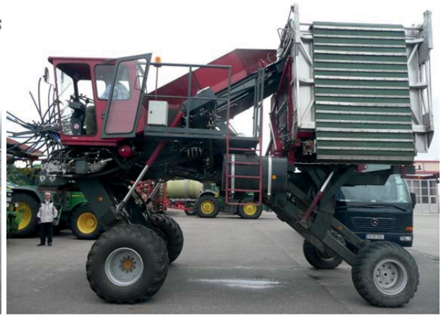
Kuva 69. Tyrnipuumuri sivukuvassa. Koneen rungon korkeutta voi nostaa aina kolmeen metriin asti, joten leikkuukorkeudessa on säätövara.
