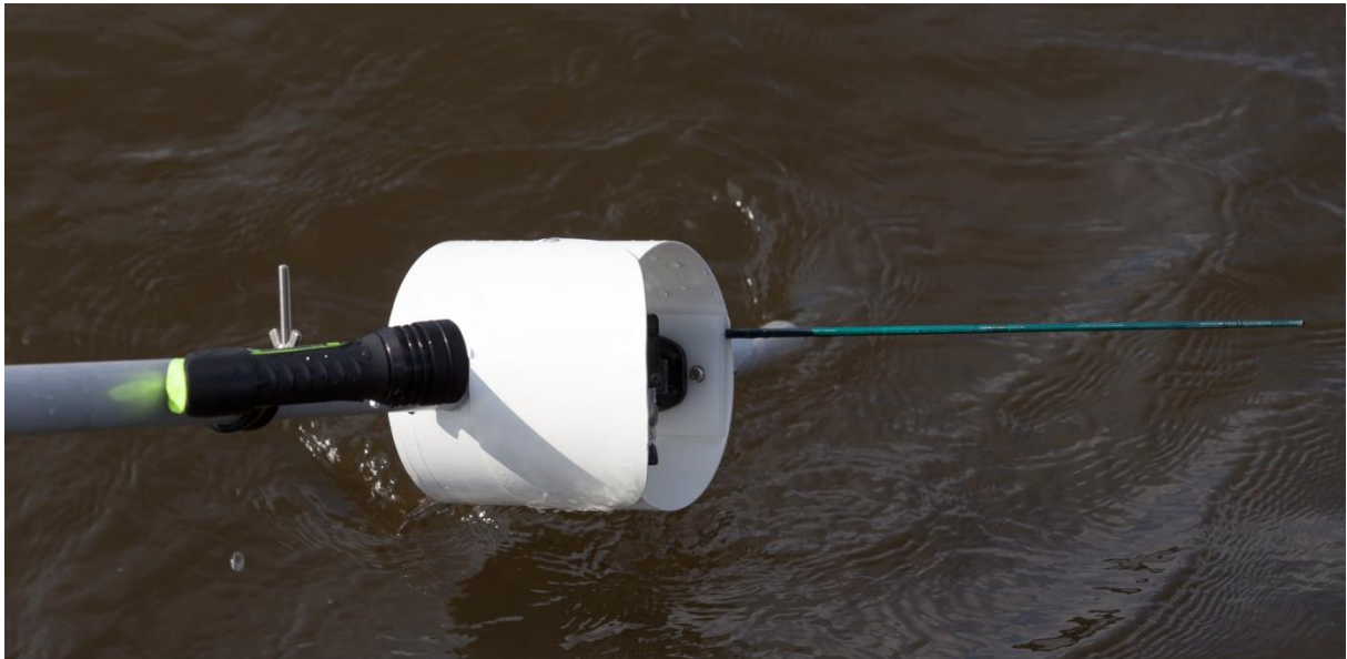
Kuva 20. Pohjien kuvauksessa käytettiin 6 m varren päähän asennettua GoPro -kameraa ja erillistä valoa.
