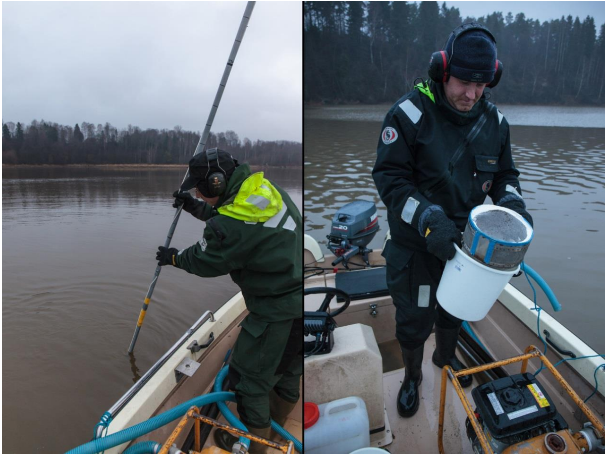
Kuva 14. Mädin pumpppausta Lammaistenlahdella syksyllä 2015. Pumpun suulake ohjattiin pohjaan pitkän varren avulla ja pumpusta tuleva vesinäyte kerättiin siivilään, josta se huuhdeltiin näytenpurkkeihin ja säilöttiin etanoliin myöhemmin tehtävää määrittystä varten.
