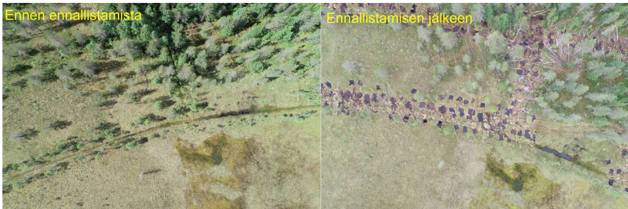
Kuva 2. Yksittäiset, osana kartoitusprosessia otetut dronikuvat Nurmeksen Mujejärven Loukkusuolta (ennen ja jälkeen ennallistamisen). Kuvassa erottuvat tukitut ojat, kuopat, joista maa-ainesta on otettu tukkimiseen, sekä umpeen kasvanut ojanpätkä, jossa maan kantavuus ei riittänyt kaivinkonetyöskentelyyn. Kuvat: Maarit Similä.
