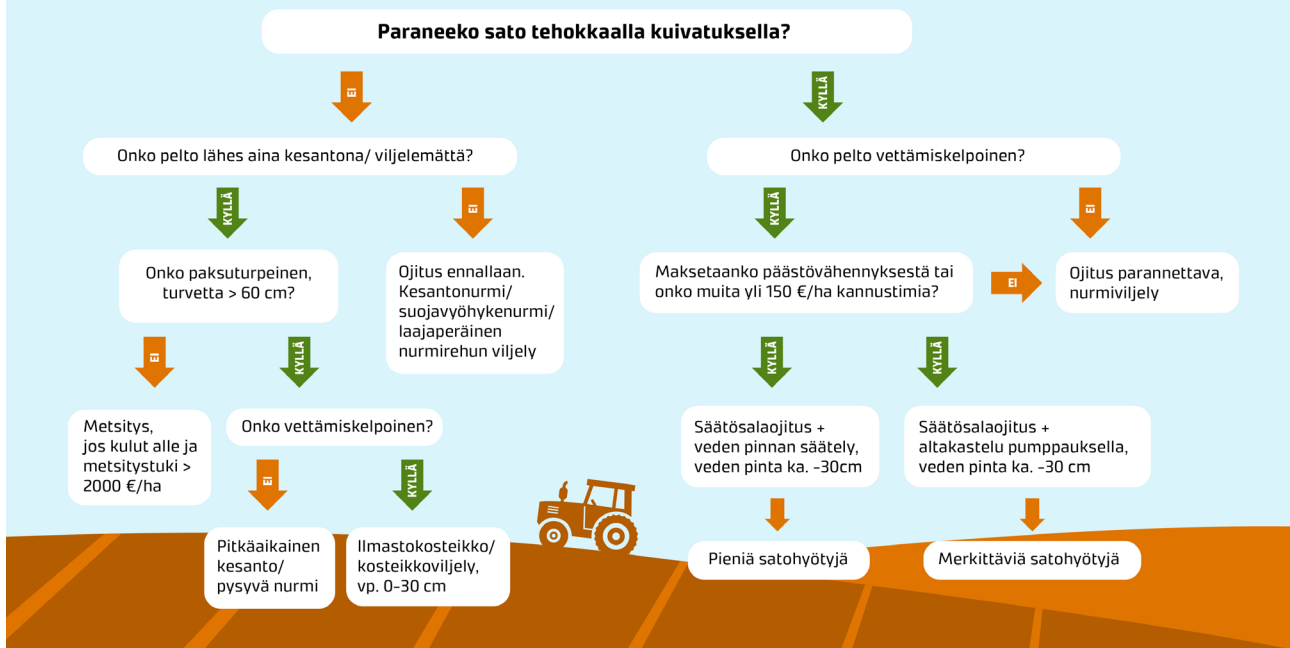
Kuva 1. Viljelijän päätöspuu heikkotuottoisen turvepellon käyttömahdollisuuksista. Altakastelussa selkeästi tavoitellaan mahdollisimman korkeaa pohjaveden tasoa, jolloin siihen voi sisältyä velvoite lisäveden ohjaamiselle, eli pumppaamiselle.
