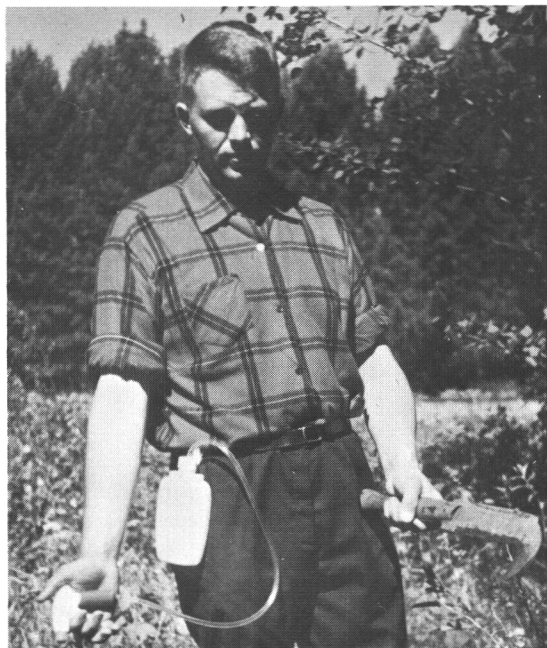
Kuva 2. Tutkimuskesän 1964 taskutus-kannonmyrkytysvälineyhdistelmä. Ruiskussa pistooliosa kiinni nestesäiliössä.
