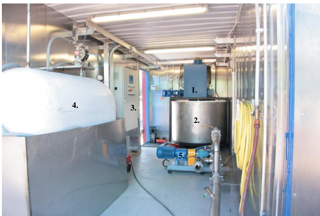
Kuva 7. Havainnekuva hapotuskontin sisältä: 1 = murskain, 2 = sekoitussäiliö, 3 = ohjausyksikkö, 4 = happosäiliö ja 5 = pumppu. (Kuva. Klaus Berglund).
