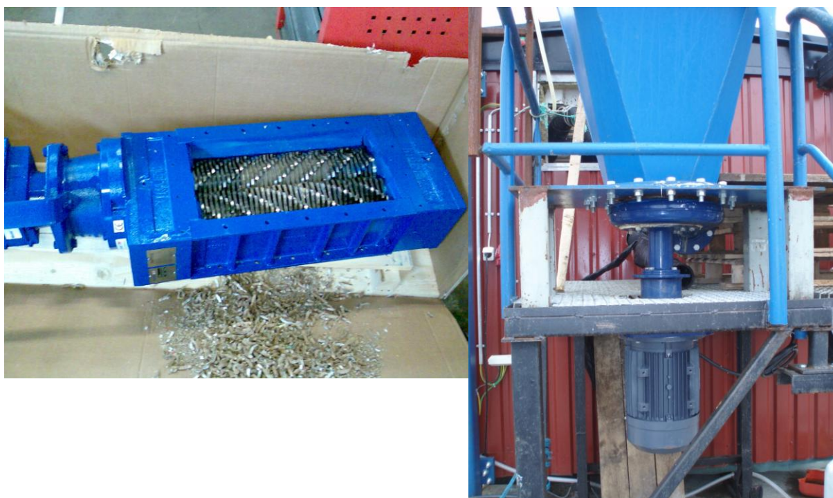
Kuva 9. Vasemmalla tehoton murskainmalli ja oikealla tehokas uppopumppumalli (Kuvat: Jari Setälä ja Klaus Berglund).
