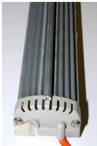
Kuva 2. Tehokkaammat (n. 100W) tankomaiset LED-valaisimet tuottavat enemmän hukkalämpöä, mikä poistuu passiivisesti valaisimen taustapuolella olevista jäähdytinriivoista. Nämäkin valaisimet voidaan sijoittaa suhteellisen lähelle kasveja. (valokuva Jarmo Holopainen)
