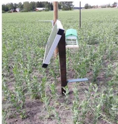
Kuva 10. Erilaisia etäluettavia ansoja testattavana Kokemäellä kesällä 2020. Tarvittava energia saatiin aurinkokennoista. Kuvat: Marja Aaltonen.
