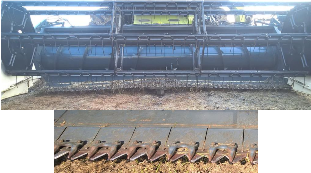
Kuva 22. Ylemmässä kuvassa näkyy Cressoni-leikkuupöydän pohjan ja terän taipuisuus: ne taipuvat pohjan alle laitetun pölkyn yli. Alemmassa kuvassa näkyy pohjapellin "palarakenne" terän takana, jonka ansiosta pohja on taipuisa. Kuvat: Matts Nysand.
