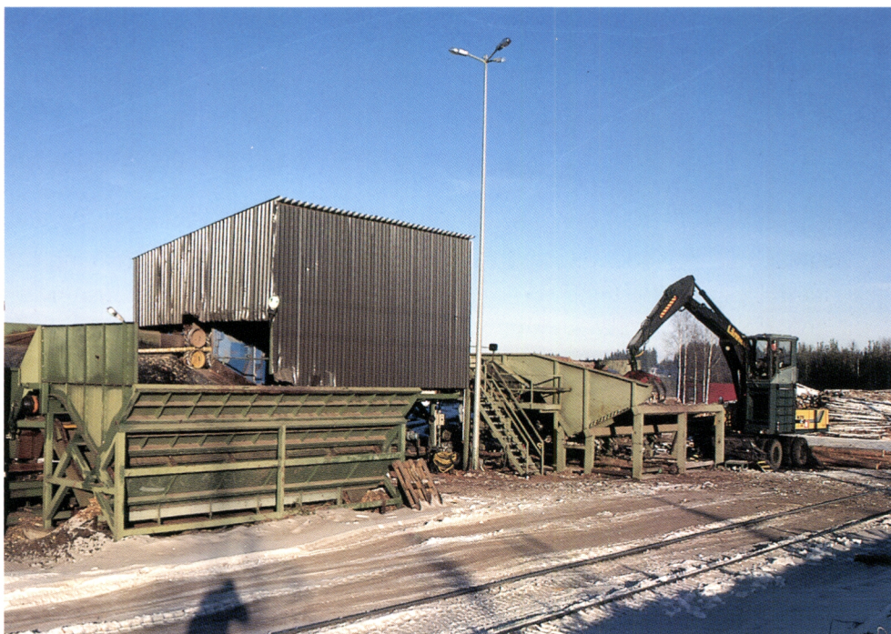
Kuva 17. Pertti Szeponiak Oy:n kuitupuun reikäroottorikuorinta-asema Imatralla.
