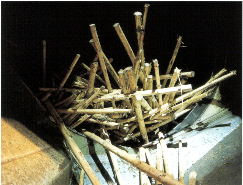
Kuva 1. Ohut ensiharvennuspuu murskaantuu kuorimarummuissa helposti, jos sitä käsitellään samanaikaisesti järeämmän kuitupuun kanssa.
