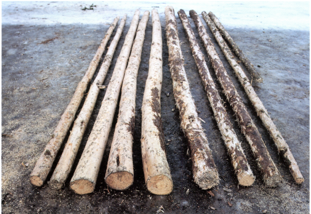
Kuva 21. Esimerkki mäntyosapuun kuoriutumuksesta yhdistelmäkuorimossa. Viisi oikealla olevaa pölkkyä on läpäissyt vain piiskauksen, viisi vasemmalla olevaa pölkkyä on läpäissyt sekä piiskauksen että rummutuksen.
