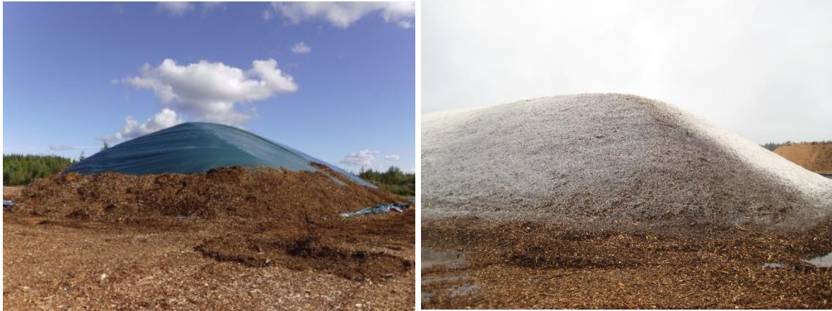
Kuva 16. Vasemmalla muovilla peitetty, oikealla LiveTech Suojalla® peitetty hakkuutähdekasa Varpaisjärven kokeessa.
