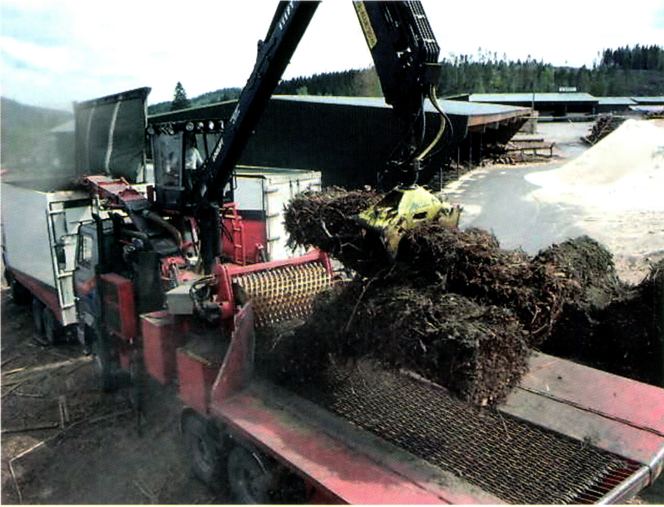
Kuva 8. LHM-Hakkuri Oy:n Giant-malli soveltuu kokopuun sekä irtonaisen tai paalatus hakuutähteen haketuksen (Kuva: Tommi Lahti).
