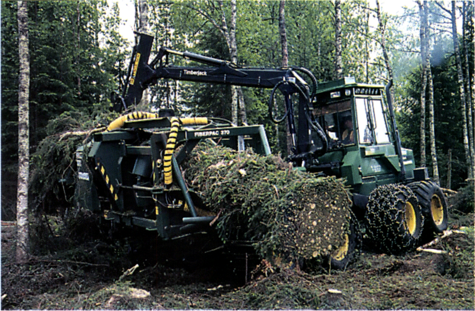
Kuva 10. Hakkuutähteen paalaminen helpottaa käsittelyä ja alentaa kaukokuljetuksen kustannuksia (Kuva: Metla / Erkki Oksanen ).
