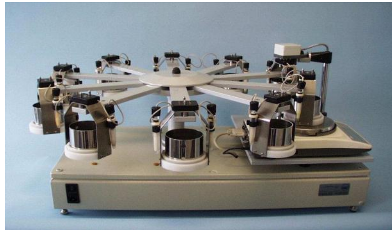
Ku-pF laite (UGT GmbH) lieriöt 250 cm 3
