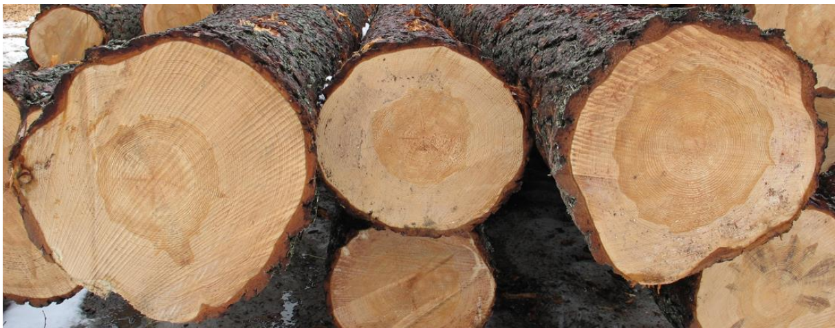
Kuva 11. Sydänpuun määrä vaihtelee tukkipokoittaisesti. Sydänpuuosuus ei ole suurimmillaan kannon korkeudella, vaan noin 20 % korkeudella puun pituuden suhteen.
