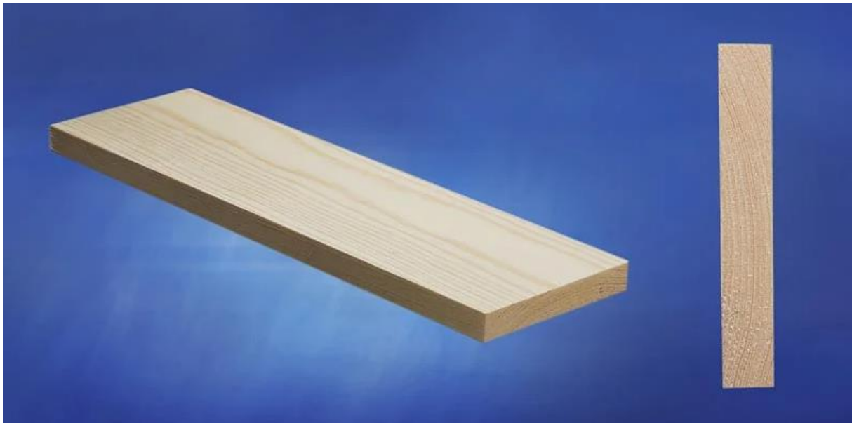
Kuva 10. Männyn pintapuu on tasaisen vaaleaa ja hyvälaatuisena oksatonta tai vähäoksaista. Kuva: Lopen rakennuspuu Oy.
