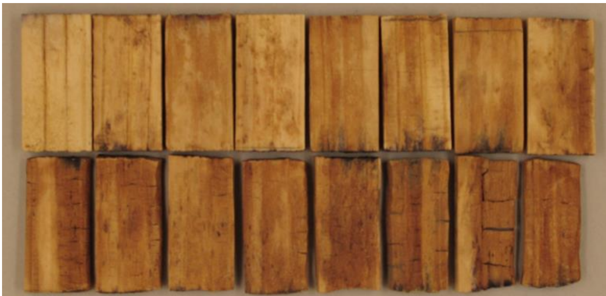
Kuva 21. Lahotuskokeessa kahdeksan viikkoa olleita ja eri asteisesti kellarisienen lahottamia männyn kaatokoepuista valmistettuja sydänpuukappaleita. Kukin puukappale on eri puuyksilöstä. Vasemmalla ylhäällä olevassa kappaleessa ei ollut havaittavissa painohäviötä, kun taas alhaalla oikealla olevasta kappaleesta oli jäljellä enää vajaa puolet ennen lahotusta mitatusta alkupainosta.
