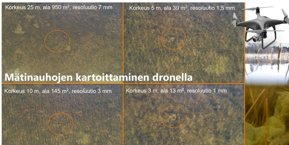
Kuva 4. Ahvenen mätinauhan erottuminen dronekuvassa eri kuvauskorkeuksilla. Kuvat: Lari Veneranta.
