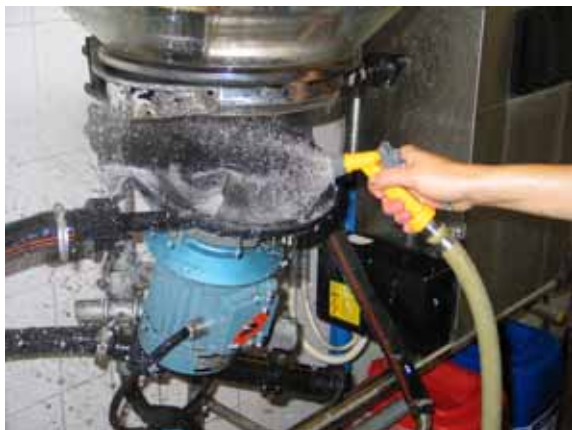
Bild 32. Slutenhetens botten och bottenpackning sköljs före cirkulationsdisken.
