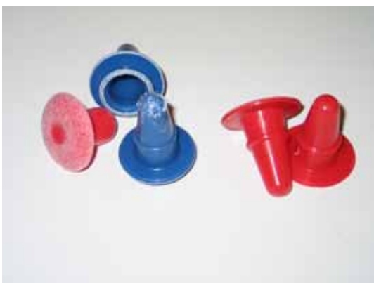
Bild 7. Propparna till vänster är slitna och svårare att rengöra ordentligt än de släta propparna till höger.
