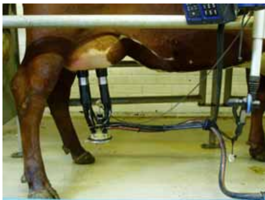
Bild 1. En servicearm som fungerar som slangstyrning på en tandemstation. Foto: Kaj Nyman.
