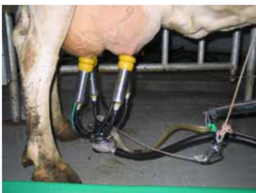
Bild 3. Här är slangstyrningen fel inställd. Mjölkningsorganet är vridet och mjölkflödet hämmas.
