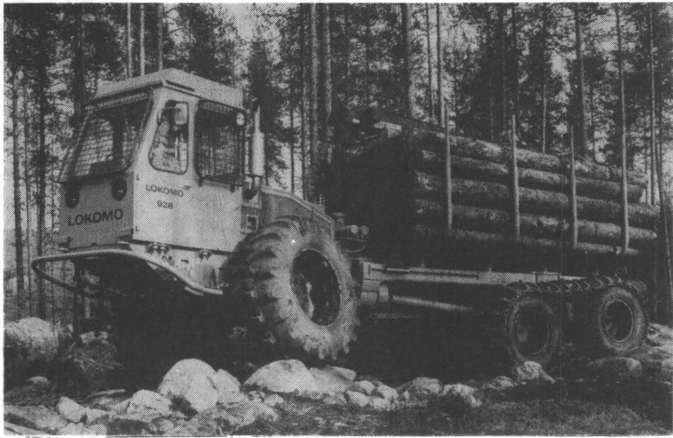
Kuva 22. Lokomo 928 kuormatraktori (valokuva Rauma-Repola Oy, Lokomo).
