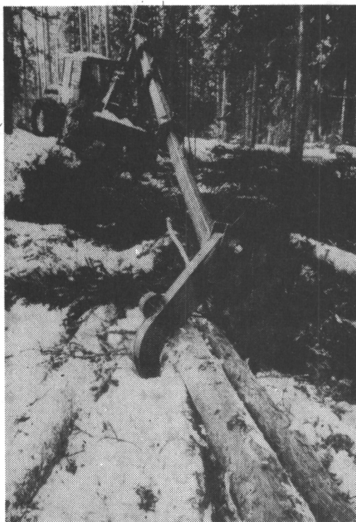
Kuva 11. Normet esikasaussyksikkö (valokuva Orion Yhtymä Oy, Normet).
