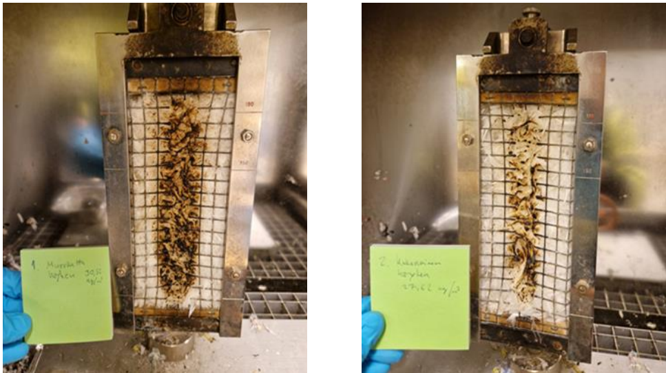
Kuva 4. Murskatun ( 30,52 \text{ kg/m}^3 ) ja kokonaisen ( 27,62 \text{ kg/m}^3 ) höyhenen palontestausta. Kuva: Akseli Romppainen, Ecoup Oy.
