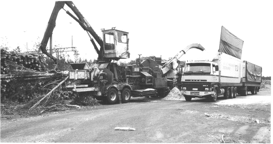
Kuva 1. Peterson Pacific DDC 5000 ketjukarsinta-kuorinta-haketusyksikkö Enso-Gutzeit Oy:n Vuoksenlaakson puutavaravarastolla. Figure 1. Peterson Pacific DDC 5000 flail delimeter-debarker-chipper at the Vuoksenlaakso timber terminal of Enso-Gutzeit Oy.
