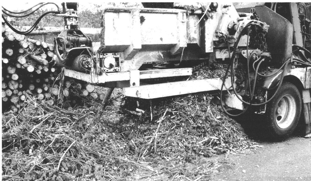
Kuva 5. Syöttötähte koostuu elävistä ja kuolleista oksista. Figure 5. Infeed residue is composed of live and dead branches.
