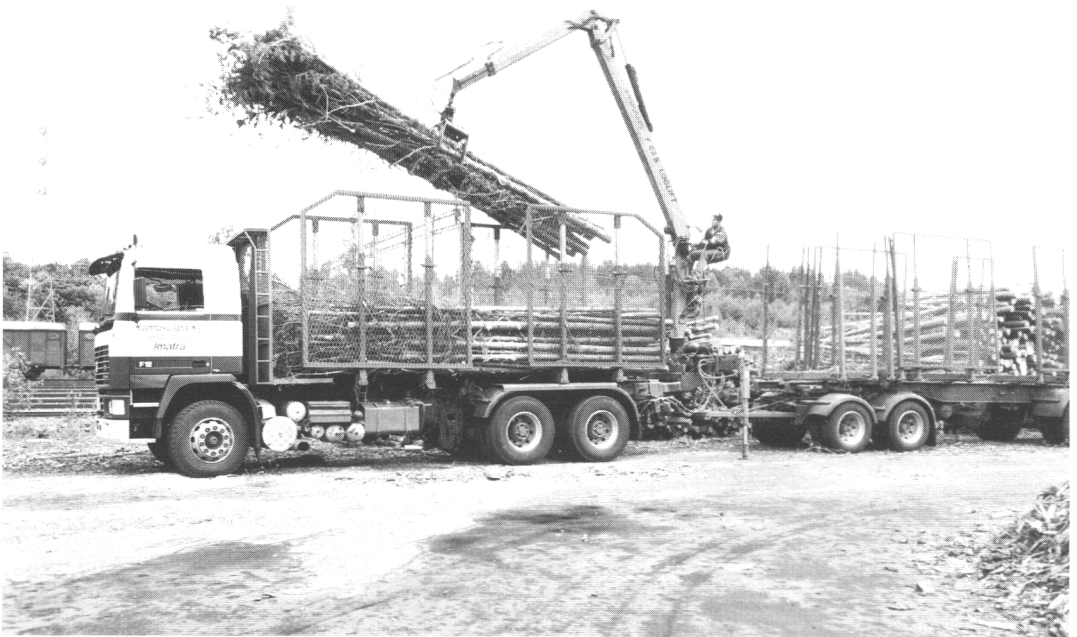
Kuva 2. Osapuun kuljetukseen varustettu puutavara-auto. Figure 2. A timber truck equipped for the transport of 5 m tree sections.
