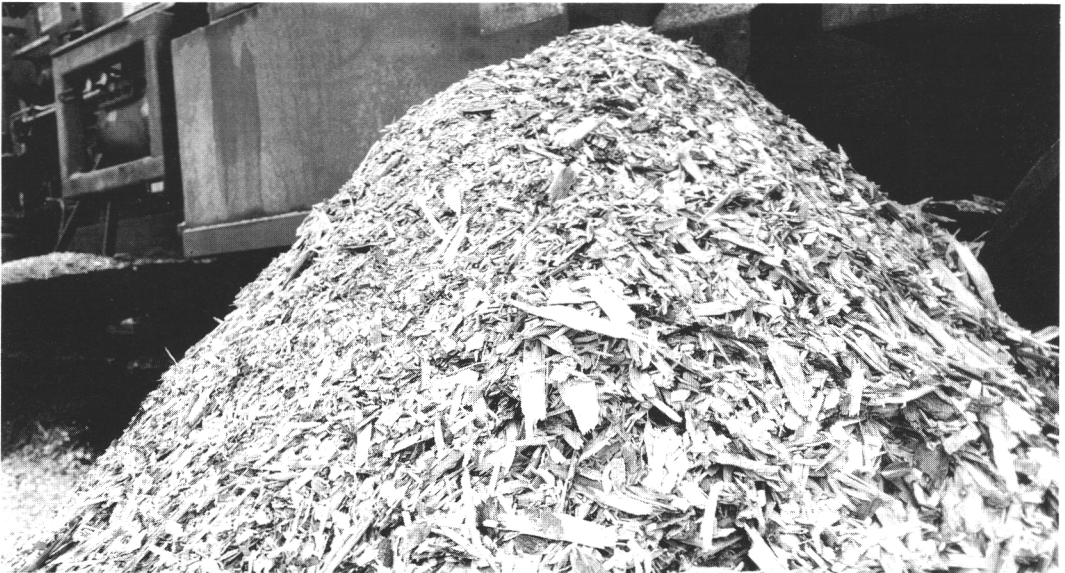
Kuva 7. Separattoritähteessä on 80 % puuta ja 20 % kuorta. Figure 7. Separator residue contains 80 % stemwood and 20 % bark.
