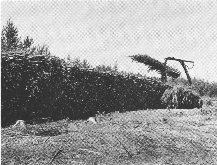
Figure 17. Unloading whole trees at the upper landing site. Kuva 17. Kokopuukuormaa puretaan väliavarastolla.
