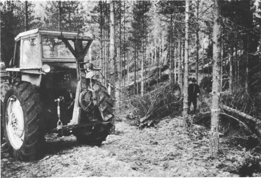
Figure 14. A Farmi JL 30 winch mounted on a farm tractor. Kuva 14. Farmi JL 30 vintturi maataloustraktoriin sovitettuna.
