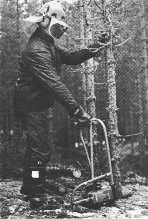
Figure 6. The Jaaranen-Rantapuu felling frame lightens and speeds up manual felling and bunching. Kuva 6. Jaaranen-Rantapuu kaatokabvojen käyttö keventää ja nopeuttaa kaatoa ja kokonaisten puitten kasausta.
