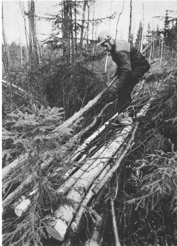
Figure 5. Manual felling and bunching of whole trees is ergonomically difficult if a standard power saw is used (photo Oy W. Rosenlew Ab). Kuva 5. Kaato ja kokonaisten puitten kasaus on ergonomisesti vaikeata käytettäessä vakiovarusteista moottorisahaa (kuva Oy W. Rosenlew Ab).
