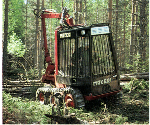
Makeri laahustraktori Makeri clam skidder
