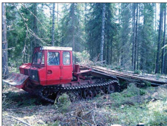
Рис. 3.34. Канатно-чokerная модель гусеничного трелевочного трактора ТЛТ-100А (слева) и гусеничная модель ТБ-1МА-15 (справа) с гидроманипулятором.
