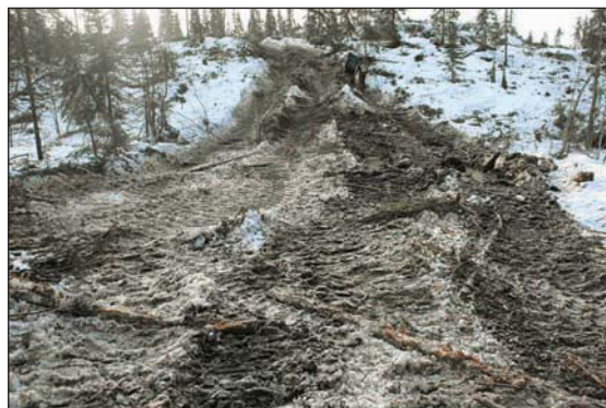
Рис. 3.59. Результаты нескольких проходов форвардера (слева) и гусеничного трелевочного трактора (справа).
