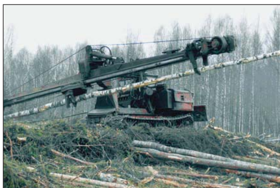
Рис. 3.58. Сучкорезная машина ЛП -30 (слева) и процессор Hitachi на экскаваторном шасси (справа).
