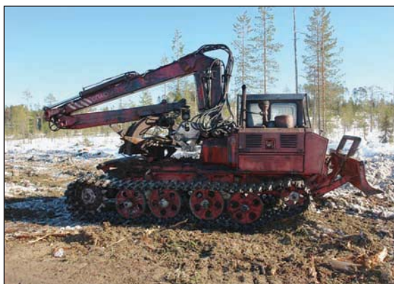
Рис. 3.34. Канатно-чokerная модель гусеничного трелевочного трактора ТЛТ-100А (слева) и гусеничная модель ТБ-1МА-15 (справа) с гидроманипулятором.
