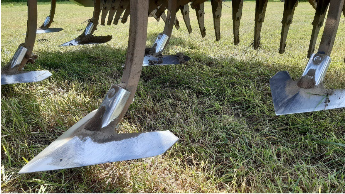
Kuva 11. Edessä KwickFinnin kultivaattoriosan hanhenjalkaterät ja takana roottorin kovapalaterät, jotka olivat tarpeen Jokioisten savimaalla. Kuva Pentti Ruuttunen.
