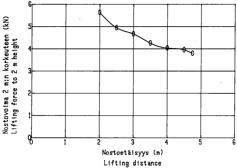
Kuva 2. Kuormaimen nostovoiman riippuvuus nostoetäisyydestä. Figure 2. The lifting force of the loader as a function of the lifting distance.
