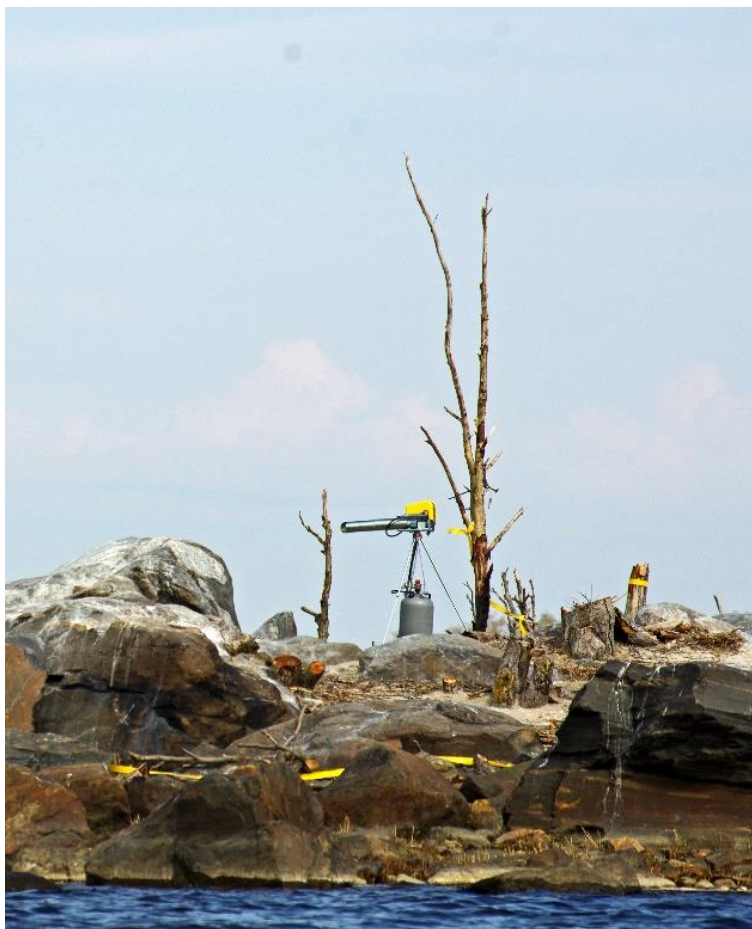
Kuva 11. Merimetsojen karkottamiseen käytetty nestekaasukäyttöinen tykki Merikarvian Lankoslahdella. Kuva: Pekka Salmi
