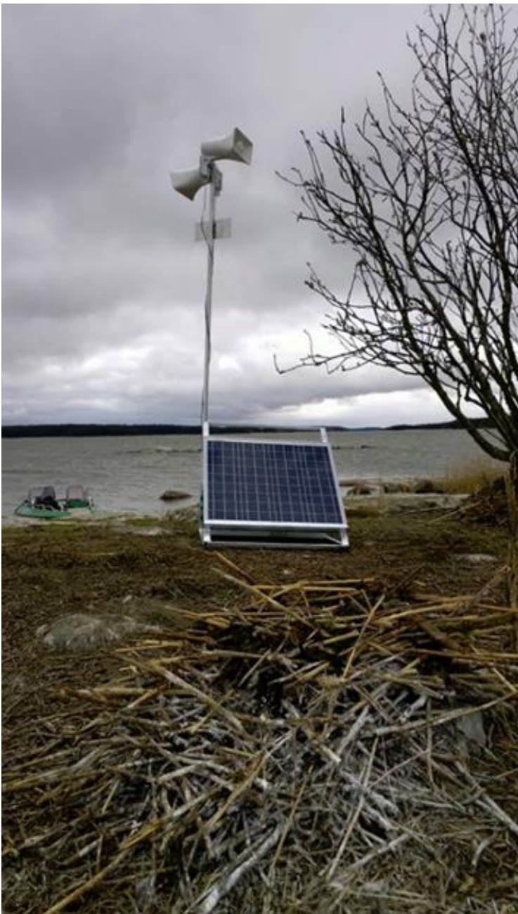
Kuva 13. Äänikarkotin, jossa on aurinkopaneelit, akut, kaiuttimet ja soitin, joka lähettää merimetson varoitusääntä. Kuva: Timo Saarinen
