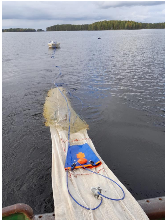
Kuva 30. Välikappale ja vedenalaiskamerat valmiina koekalastukseen.
