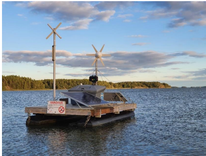
Kuva 25. Karkotinlaitteisto sähköntuottolaitteineen ponttonilautalla Naantalin Särkäsalmessa
