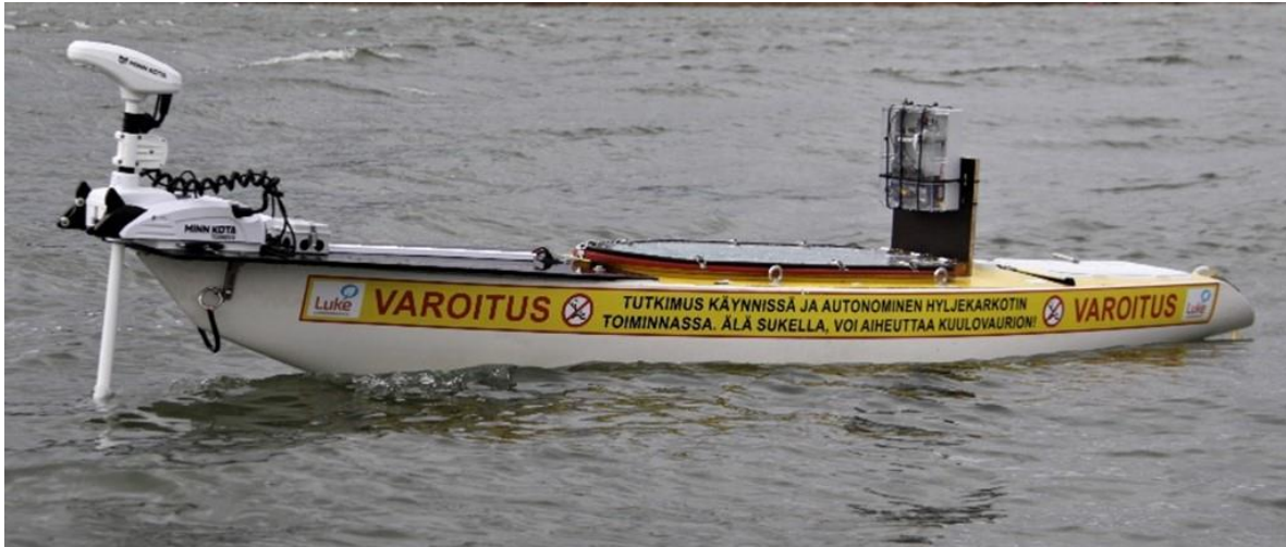
Kuva 28. Vahtikoiran prototyyppi Mark-I, jota testattiin merellä syksyllä 2021.
