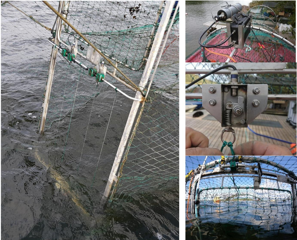
Kuva 21. Hylkeen uudessa rysän välipesään se aktivoi porttikehikon dyneemalankoihin kytkeytyä lähestymiskytkimen ja kalteriportti sulkeutuu.
