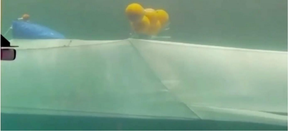
Kuva 29. Lajitteluvälikappaleen säleikköosa, poistumisikkuna ja sivusaalispussi kuvattuna virtausaltaassa Hirtshalsissa Tanskassa.
