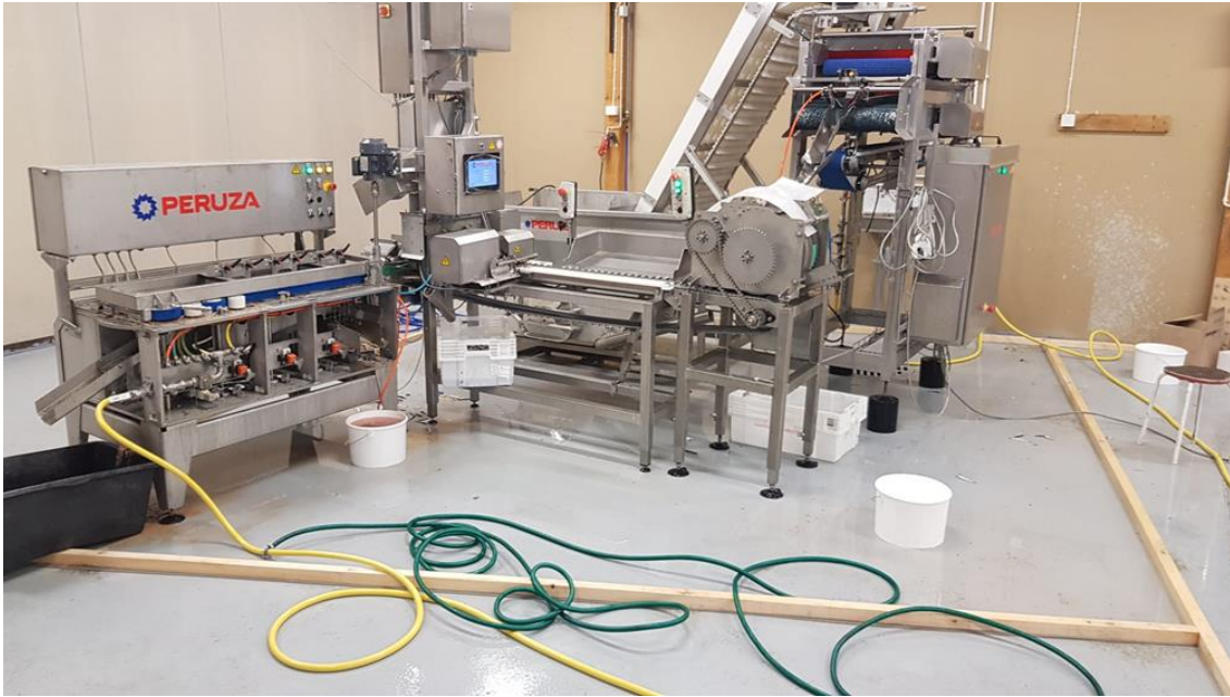
Kuva 13. Perkuukoneen testiasetus vuonna 2022 Kerimäellä. (kuva Samuli Taponen)
