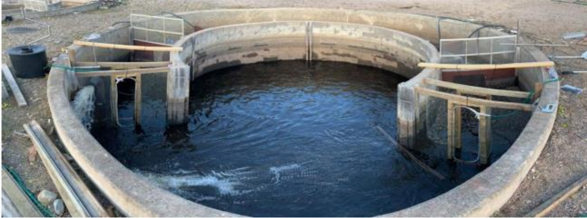
Kuva 18. Kuhakokeissa käytetty koeallas ja nielukoejärjestelyä Kainuun kalantutkimusasemalla.
