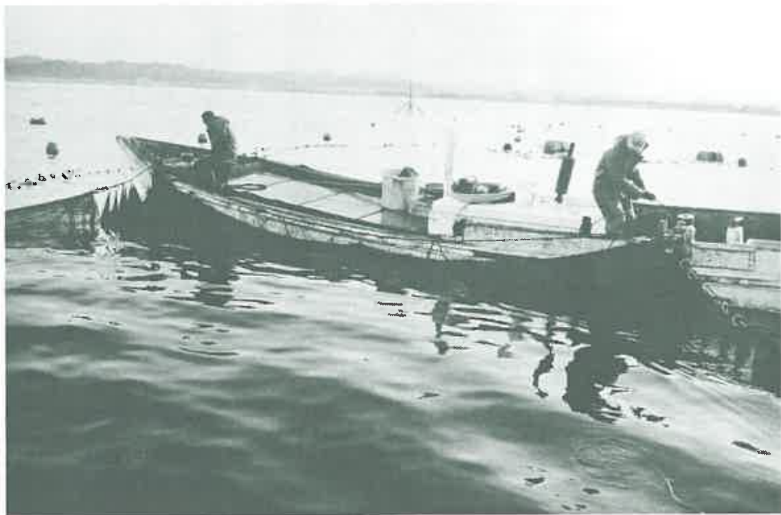
Kuva 14. Yläkuvassa näkyy kokeilurysän perä ja osa nieluista. Alakuvassa perän liinaus käynnissä. Liinauksessa käytetään pieniä vinssejä, joiden avulla perän pohjaan ja sivuille rautarenkaiden avulla viritetyt köydet nostetaan.
