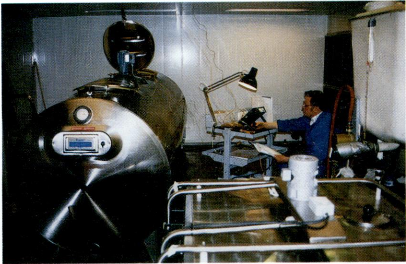
Alipainesäiliön jäähdytystehon mittaus vakio-olosuhteissa.
