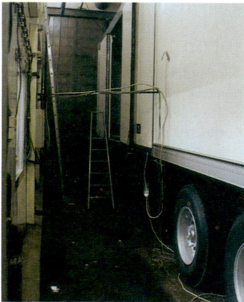
ATP-tyypitarkastuksessa lämmitetään ajoneuvon kuormatilaa vakioteholla ja mitataan sisä- ja ulkolämpötilan ero, jolloin voidaan laskea kuormatilan seinämän K-arvo.
