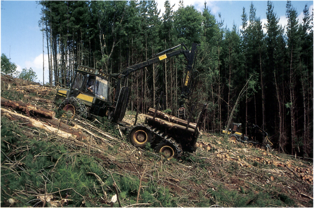
Kuva 18. Ponsse S15-kuormatraktori tutkimustyömaalla. Rinteen kaltevuus on 35 %.
