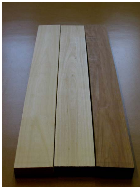
Kuva 46. Lämminilma-kuivatun (vas.), puristuskuivatun (kesk.) ja lämpökäsitellyn (oik.) haapalaudan höyläpintaa.
