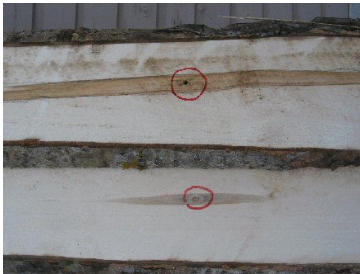
Kuva 22. Kasvukairan reiästä levinnyt värivika ja laho haapasaheissa. Alempana pintasahe ja ylempänä seuraava sahe kohti tukin ydintä. Kuva: Reijo Junkkonen.
