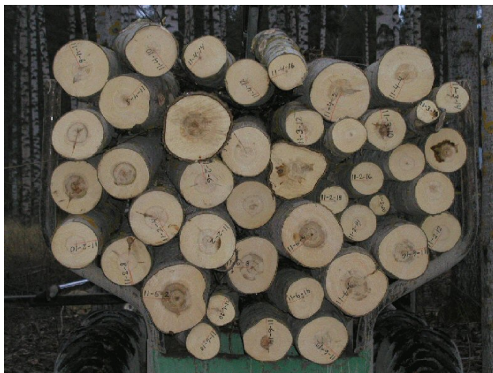
Kuva 23. Koetukkikuorma Hämeenkyrössä. Tukkien päissä näkyy yleisesti väri- ja lahovikoja. Kuva: Erkki Salo.
