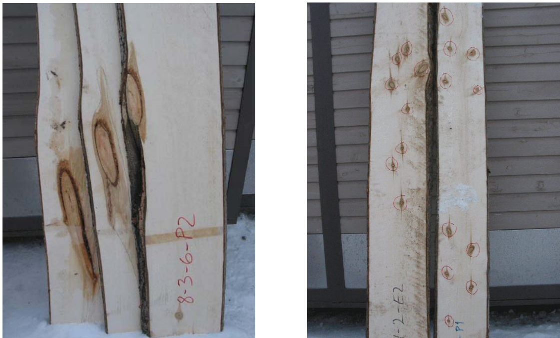
Kuva 33. Pystyoksa noin viiden metrin korkeudella (vas.) ja oksaryhmiä hybridihaapasahaissa. Kuvat: Reijo Junkkonen.
