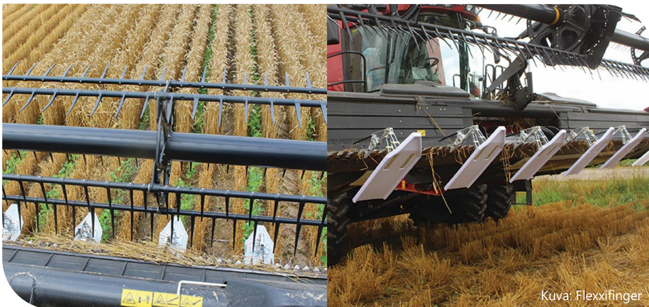
Kuva 8. Kumppanikasvien kaistaleveydet voidaan valita tilanteen mukaan. Tehdastekoisia kaistasuksia puimuriin on myös erilevyisiä tilattavissa ulkomailta. Kuvissa on Flexifingerin yksirivinen sovellus.
